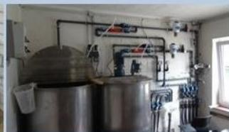
**Wirkstoff-Mischbehälter aus Edelstahl** mit freihängendem Langsamläufer-Spezial-Rührwerk
